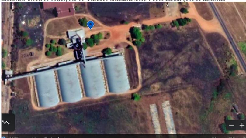
Complexo da UA Imperatriz -MA com destaque para os quatro galpões graneleiros, autoportante, fundo plano. À direita a BR 10 e à esquerda ponto de carregamento de vagões. Ao fundo se vê parte do galpão convencional. **Fonte Google Earth Pro18/08/2020.**
