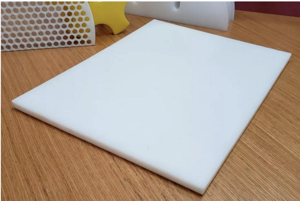
Figura - Ilustração da placa de polietileno de ultra alto peso molecular - UHMW
