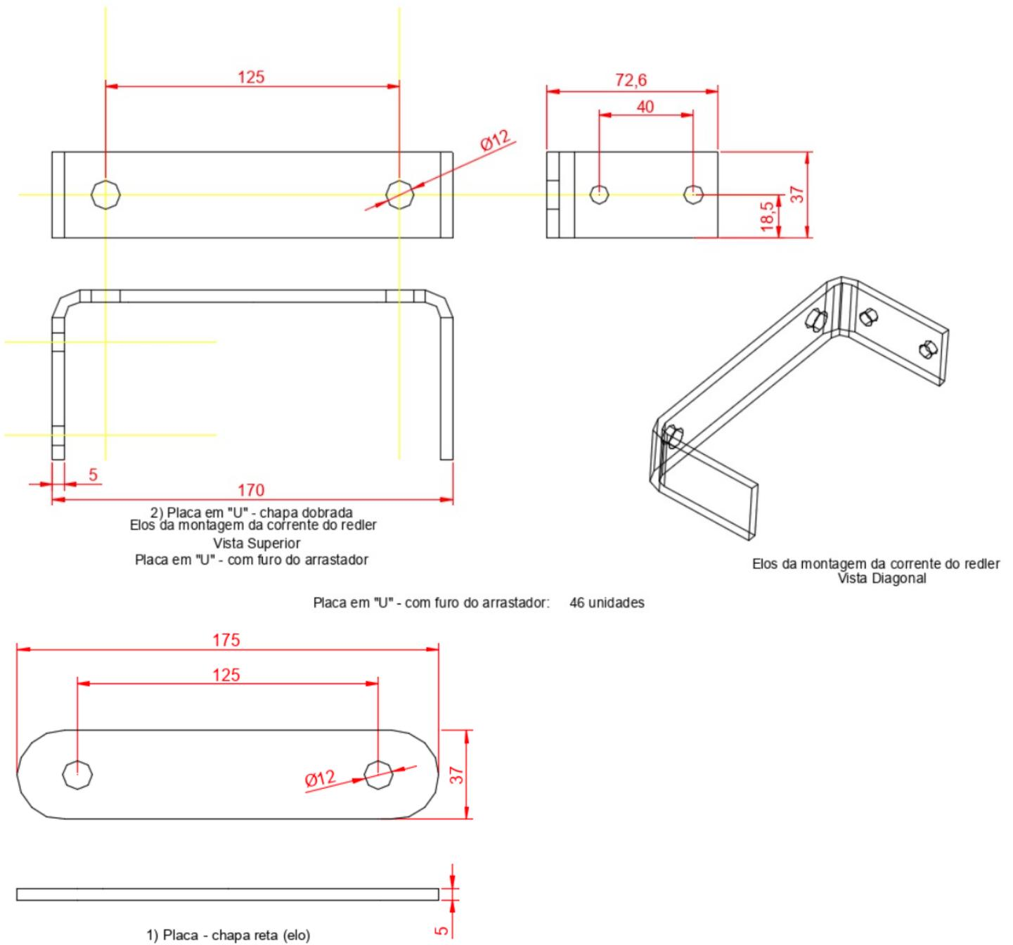
Figura - Ilustração das dimensões da corrente do redler com chapas em "U"
