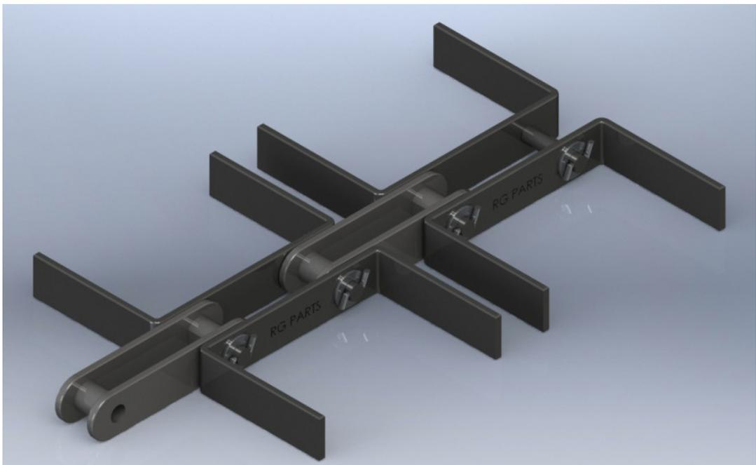
Figura - Ilustração da montagem da corrente do redler com chapas em "U"
