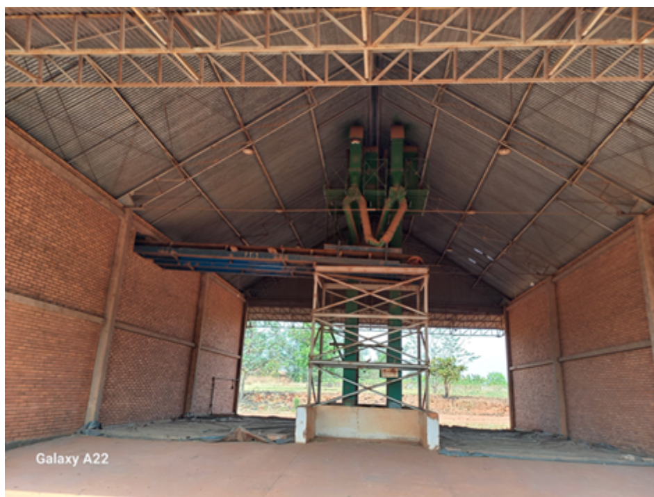
Vista geral da moega dupla, com dois elevadores (E1 e E2) e dusa fitas horizontais (Fita 1 e Fita 2)
