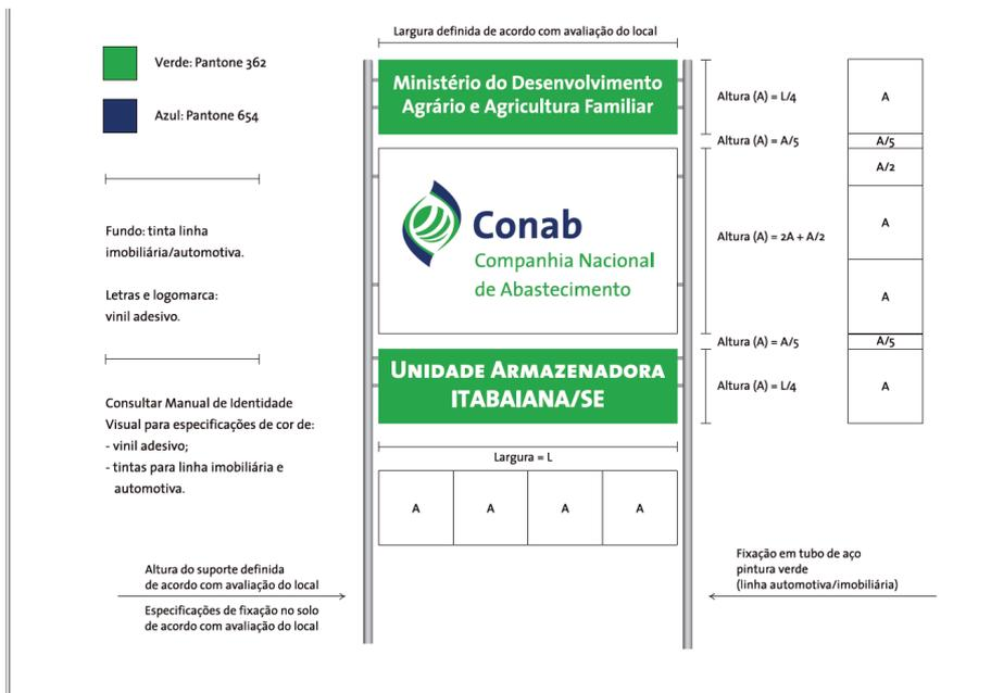
7.2.2. Instalação de Painel da Sede da Superintendência Regional de Sergipe, c/ Estrutura de Sustentação e Placas Metálicas, Adesivos Vinis e Chumbação em Concreto, conforme seguintes especificações e modelo proposto:
