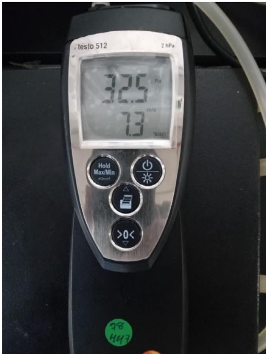
Figura 05: Início da pressurização.
