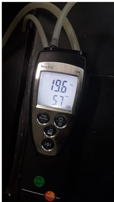
Figura 03: Início da pressurização.
