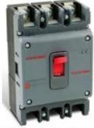
Disjuntor caixa moldada termomagnético tripolar curva C com corrente nominal 160A, com Icc mínimo de 35KA/380V, Fixação em parafusos ou trilho DIN, temperatura de trabalho 30°C. com certificação de segurança do INMETRO.
