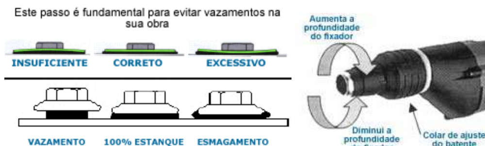
Figura 4: Recomendações para execução da fixação.
