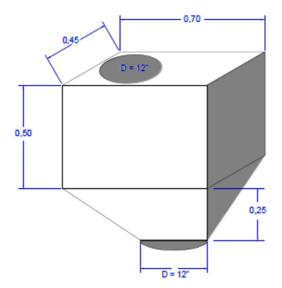
Na sequência, após a instalação dos amortecedores intermediários, deverá ser dada continuidade na instalação dos tubos, com mais 14 m. Assim, na região limítrofe do final da proteção da estrutura do silo, deverão ser instalados os amortecedores finais. O diagrama esquemático abaixo dos amortecedores finais é apresentado a seguir:
